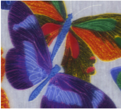
a.) Druckrapportverschiebung (z. B. gelb und rot)
