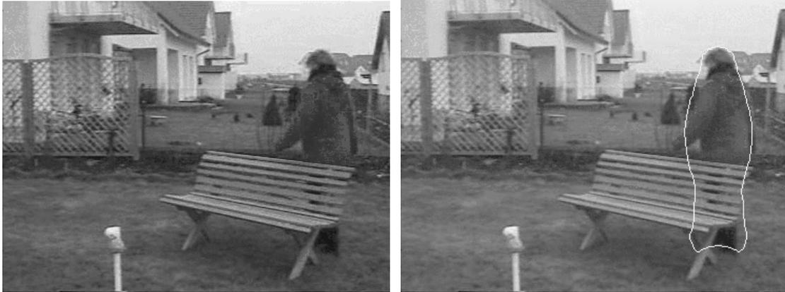
**Abb. 3:** Links: Erstes Bild einer Testsequenz. Rechts: Initialisierung der Durchschnittsform (vgl. Farbabb. 1).
