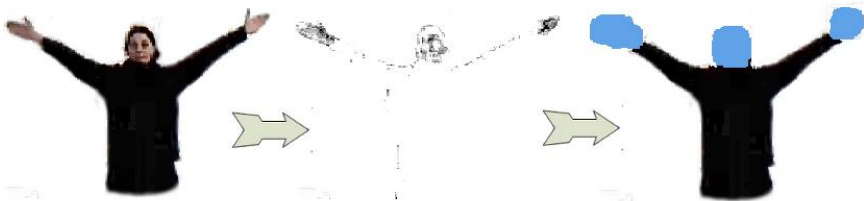
Abbildung 5.2: Bestimmen von hautfarbenen Bereichen als Connected Components von Pixeln, die mit hoher Wahrscheinlichkeit zu diesen gehören.
