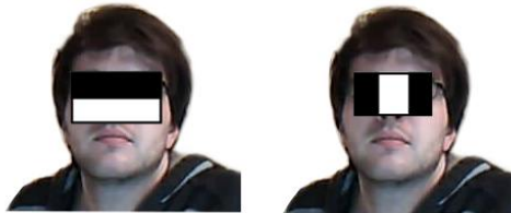
Abbildung 4.1: Beispiele wichtiger Merkmale zum Lokalisieren von Gesichtern mittels des Viola-Jones Detector
