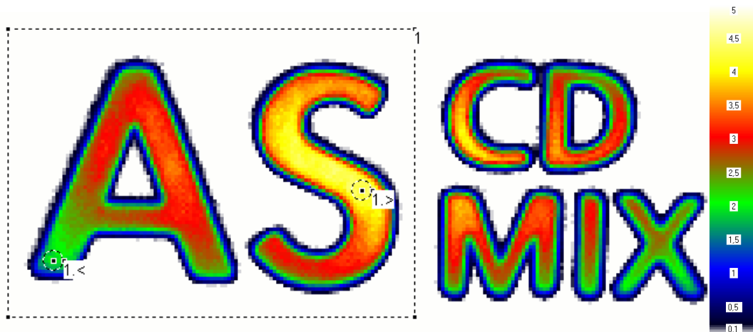
Abb. 4: Falschfarbendarstellung der Leuchtdichte eines Symbols (Farbpalette rechts). Die Position des Minimums (1.<) und Maximums (1.>) (in Äquivalenz zu einem Punktmesssystem) wird mit kleinen Kreisen markiert.
