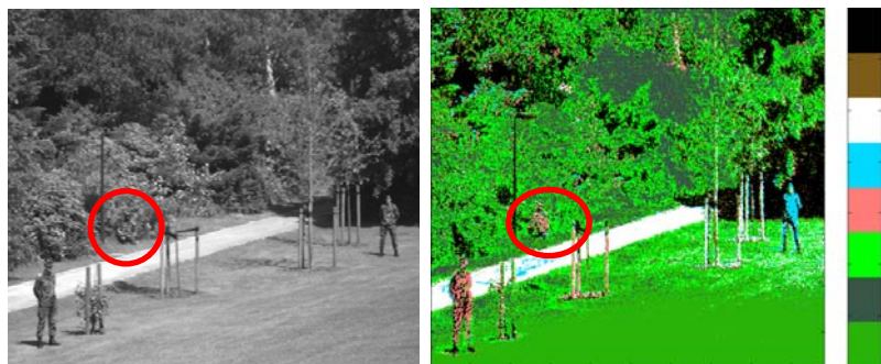
Abbildung 11. Grauwertbild und Pseudofarbdarstellung Diskriminanzanalyse 420\text{nm} - 920\text{nm} .
