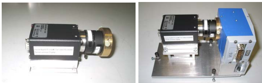
Abbildung 7. Kamera mit Objektiv und Zentrierring.
