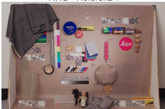
Abb. 8 Weißabgleich am Bildmotiv „Testbox“. Oben links: manuell mit Graukarte, oben rechts: AWB mit eigenem Verfahren, unten: AWB mit Vergleichskameras.
