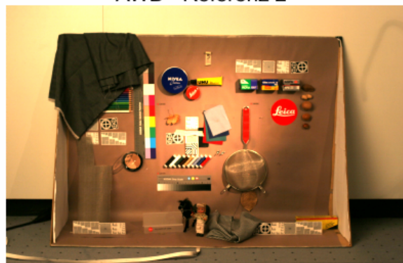
Abb. 8 Weißabgleich am Bildmotiv „Testbox“. Oben links: manuell mit Graukarte, oben rechts: AWB mit eigenem Verfahren, unten: AWB mit Vergleichskameras.
