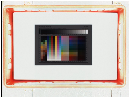
Abb. 1: Aufnahme des reflektierenden Farbtargets zur Farbkalibrierung
