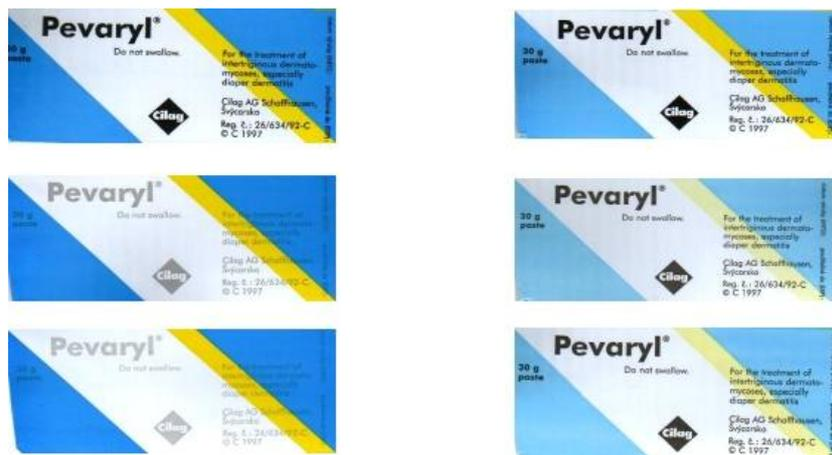
Abb. 4. Erkennen von Farbunterschieden beim Verpackungsdruck
