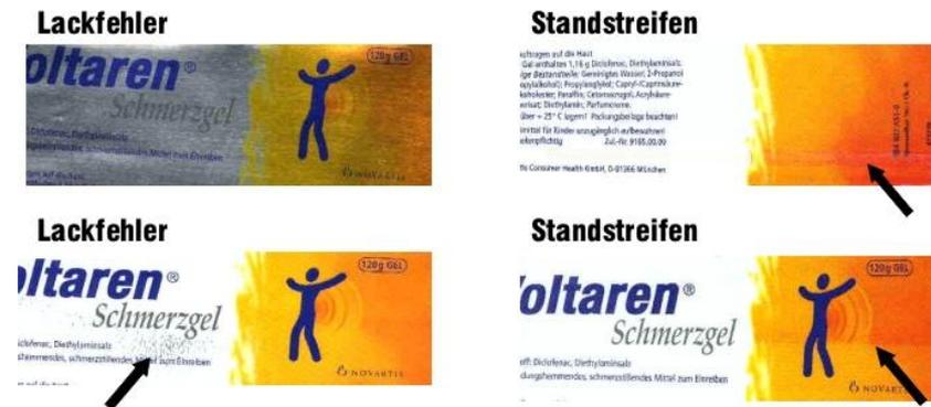
Abb. 5. Erkennen von Fehlern beim Verpackungsdruck
