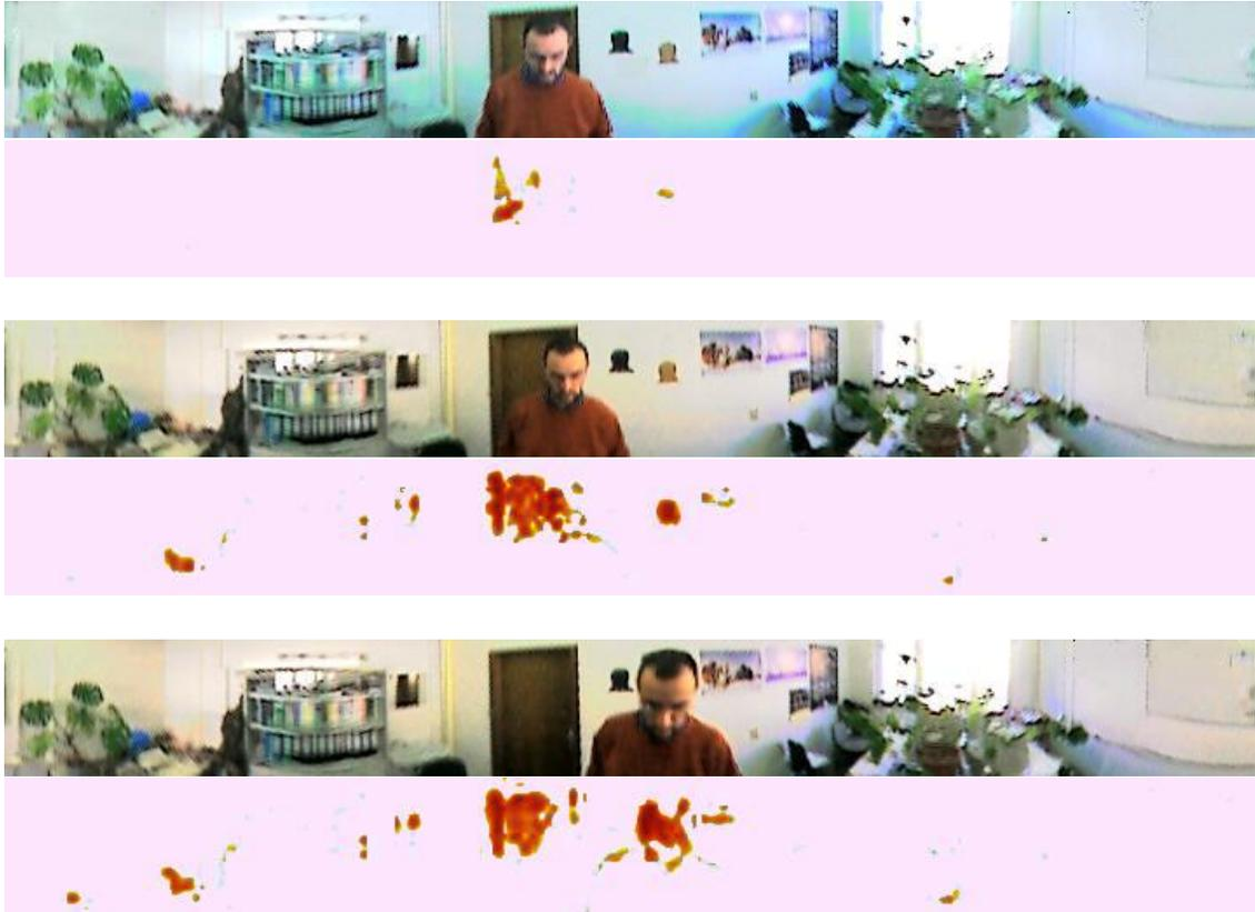
Abbildung 9: Zunehmende Detektionen des Hautfarbdetektors durch den automatischen Weißabgleich. Es handelt sich um das erste, das fünfte und das zehnte Bild einer Sequenz. Neben der eigentlichen Hautfarbregion entstehen auch mehr falsch-positive Detektionen auf holzfarbenen Objekten.
