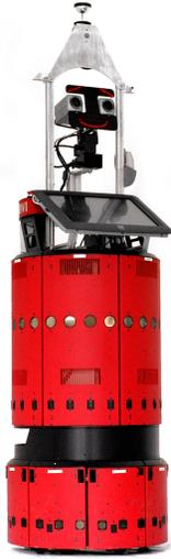
Abbildung 1: Serviceroboter PERSES mit omnidirektionaler Kamera (ganz oben) für die Nutzerdetektion und die visuelle Selbstlokalisierung. Mit einem solchen Objektiv ist es dem Roboter möglich, zu jedem Zeitpunkt sein gesamtes Umfeld zu analysieren.
