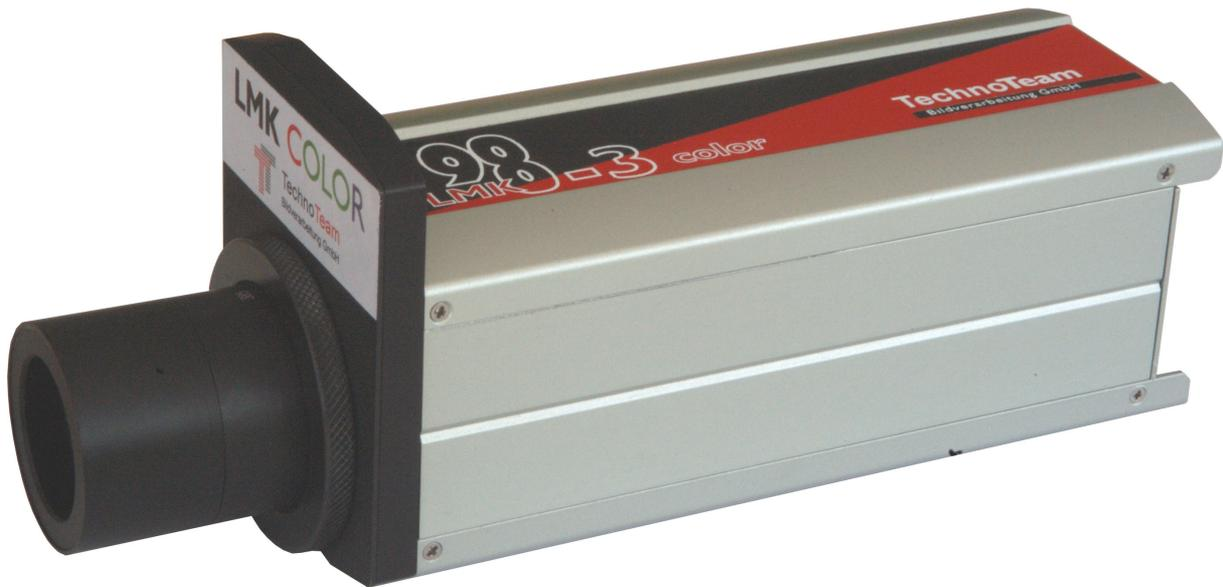
Abbildung 1: LMK 98-3 Color (CCD-Kamera mit Filterrad zwischen Objektiv und CCD-Matrix)
