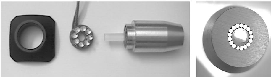
**Fig. 13.** Optikaufsatz des Form-/Farbsensor-Moduls mit Bildleitstab und integrierter Faserbeleuchtung
