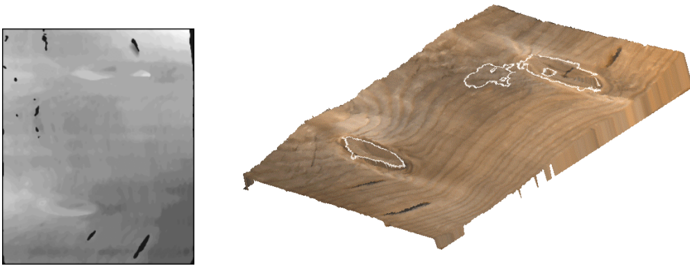
Abb. 5: Tiefenkarte (links) sowie 3d-Fusion der Tiefenkarte mit Helligkeitsinformation - (R+B)/2 - und dem Ergebnis der Astsegmentierung (rechts)
